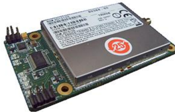
LoRaData Module 34.3x20.1x2.5mm
